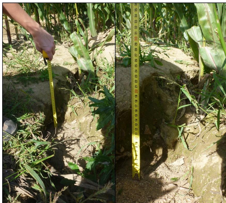
Obr. 17 Několik centimetrů hluboké a až několik desítek centimetrů široké erozní rýhy v ploše svahu
